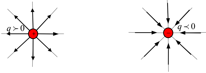
الشكل 17.1: خطوط الحقل الكهربائي لشحنة موجبة و لشحنة سالبة منفردتين
